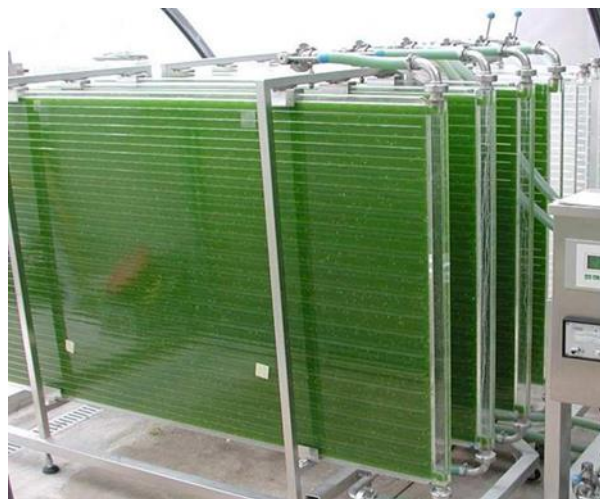
Figure 04 : Image d'un photo bioréacteur (N'goran Urbain Florent Niangoran .,2017).
